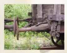
Schienenfahrzeuge brauchen Puffer. Diese sorgen Für einen Ausgleich, damit nicht der ganze Zug in eine Schwingung gerät, die immer stärker wird. Ohne Puffer würden Züge entgleisen. Puffer sind also wichtig für die Sicherheit auf der Reise.
